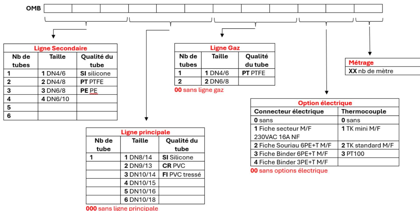
Exemple : Pour un multitube de 25m composé de 5 brins de PE 4/6, d'1 brin en silicone DN8/14 et d'un thermocouple mini => **OMB51PE11SI0001-25**
