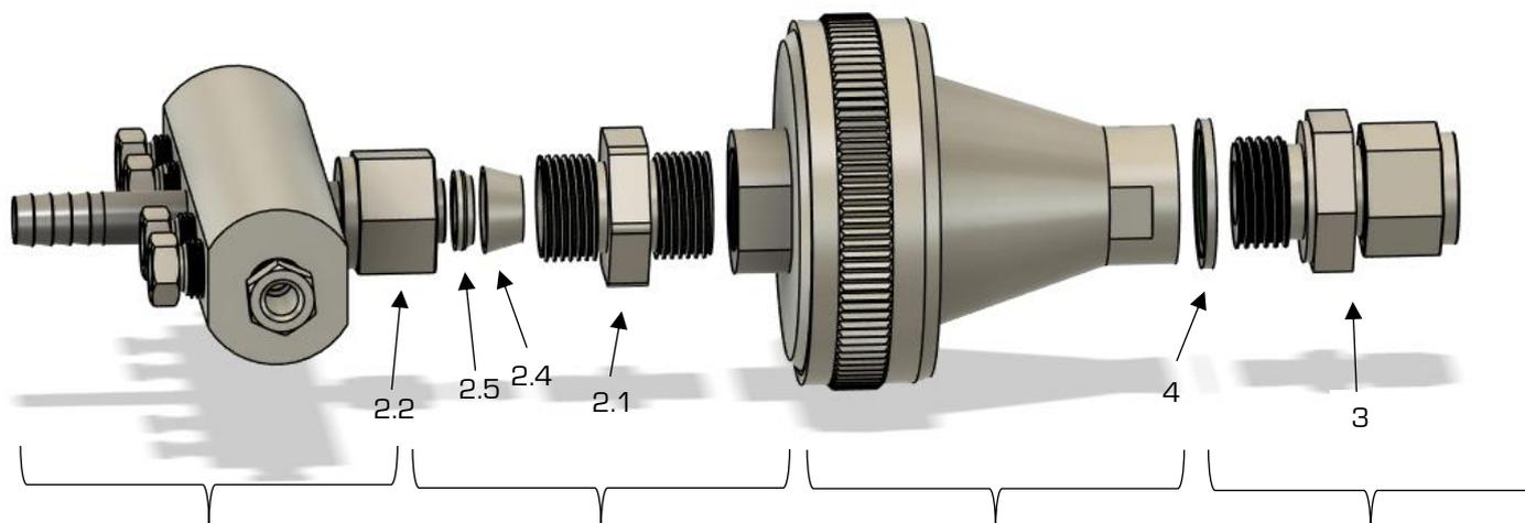
Clarinette titane **CLT2152A** avec entrée lisse 12mm. Les bagues du raccord DCFU12 sont à sertir sur l'entrée avant la 1<sup>ere</sup> utilisation.
